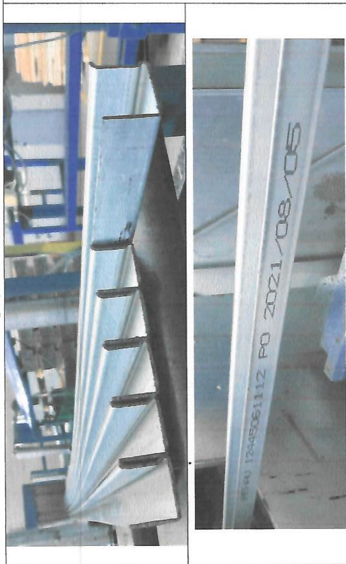
Армуючий профіль габаритами 4*27,5*35*28*8 товщина штрипса 2,0 мм
